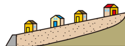
大規模盛土造成地のイメージ（大規模盛土造成地の変動予測調査ガイドラインの解説より）
