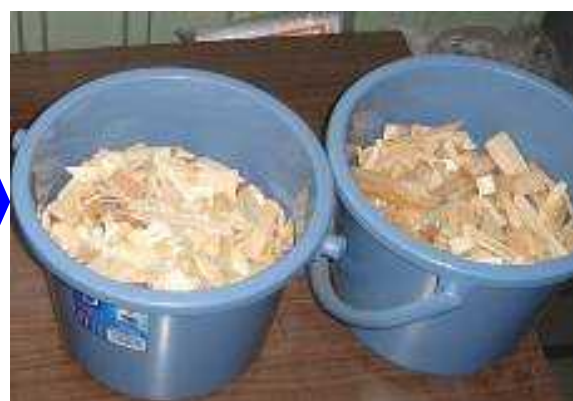
破砕機でチップ化した製材屑
