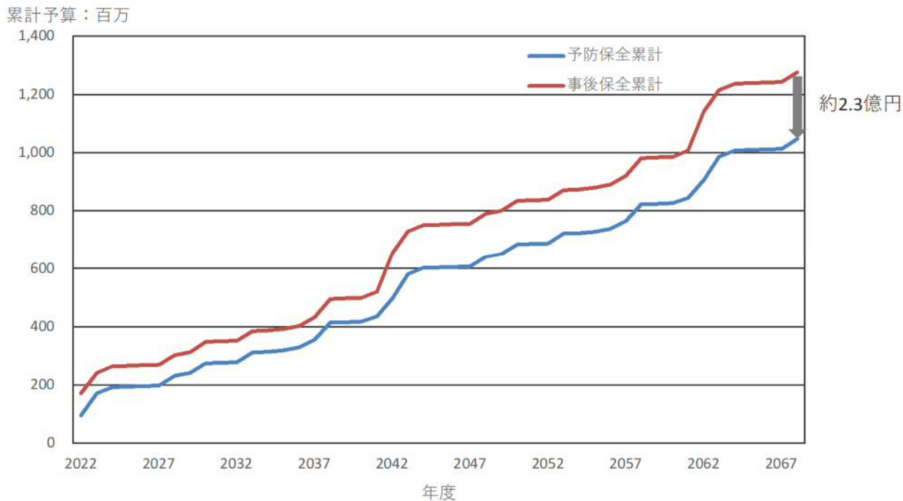
図 4.6 鳥取市トンネル（予防保全型、事後保全型）ライフサイクルコストの比較結果
