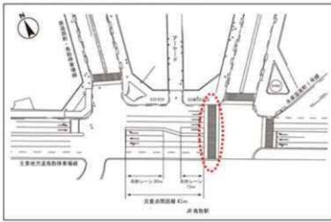
<西側部分の横断歩道設置>
