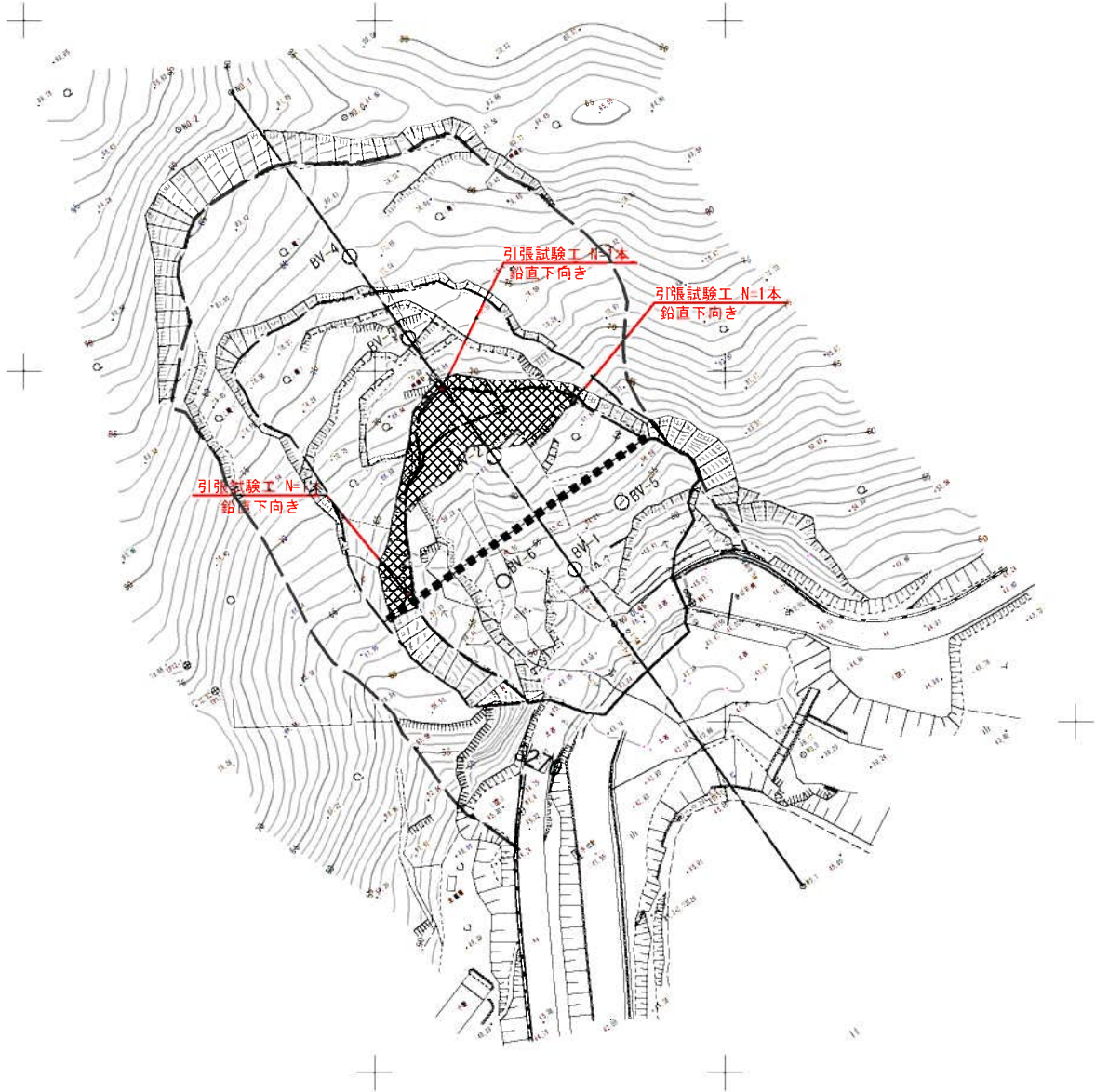
試験鉄筋挿入工 位置図 S=1:300
