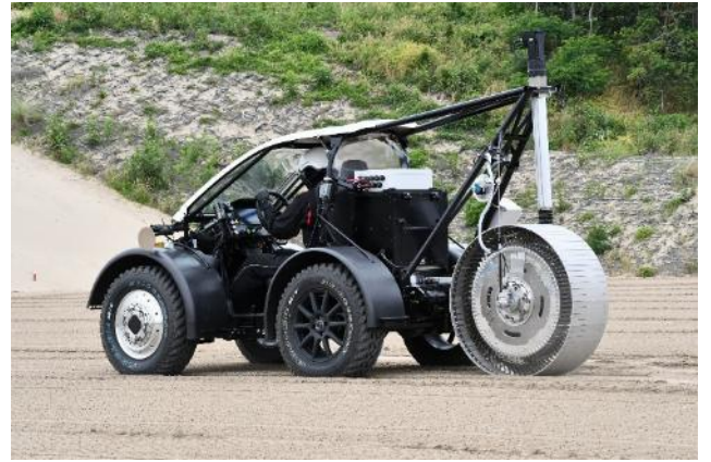
とっとりさきゅう ようす 鳥取砂丘でのタイヤテストの様子
