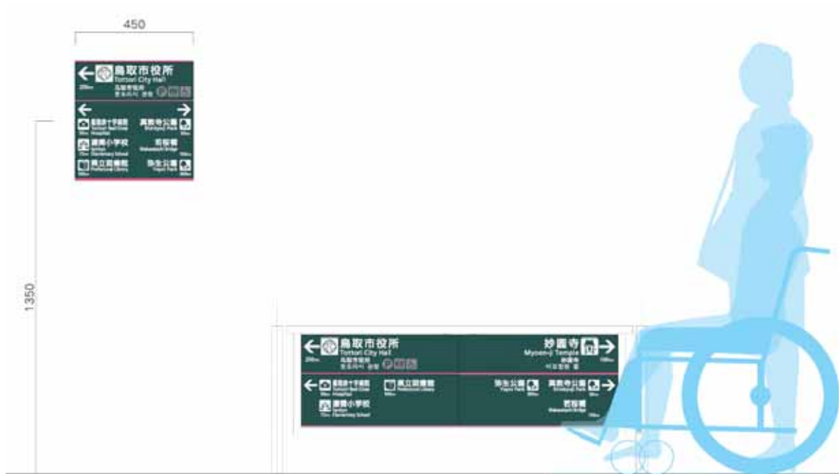
図 既存施設に誘導拠点サイン表示面を添架した例（壁掛、防護柵）
