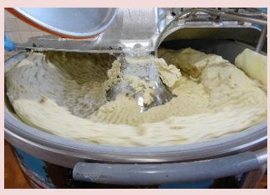
つぶした豆腐と魚(たら)のすり身に調味料を加えて機械で練ります。豆腐のかたさや、気温をみて、職人さんが練り具合を調整します。
