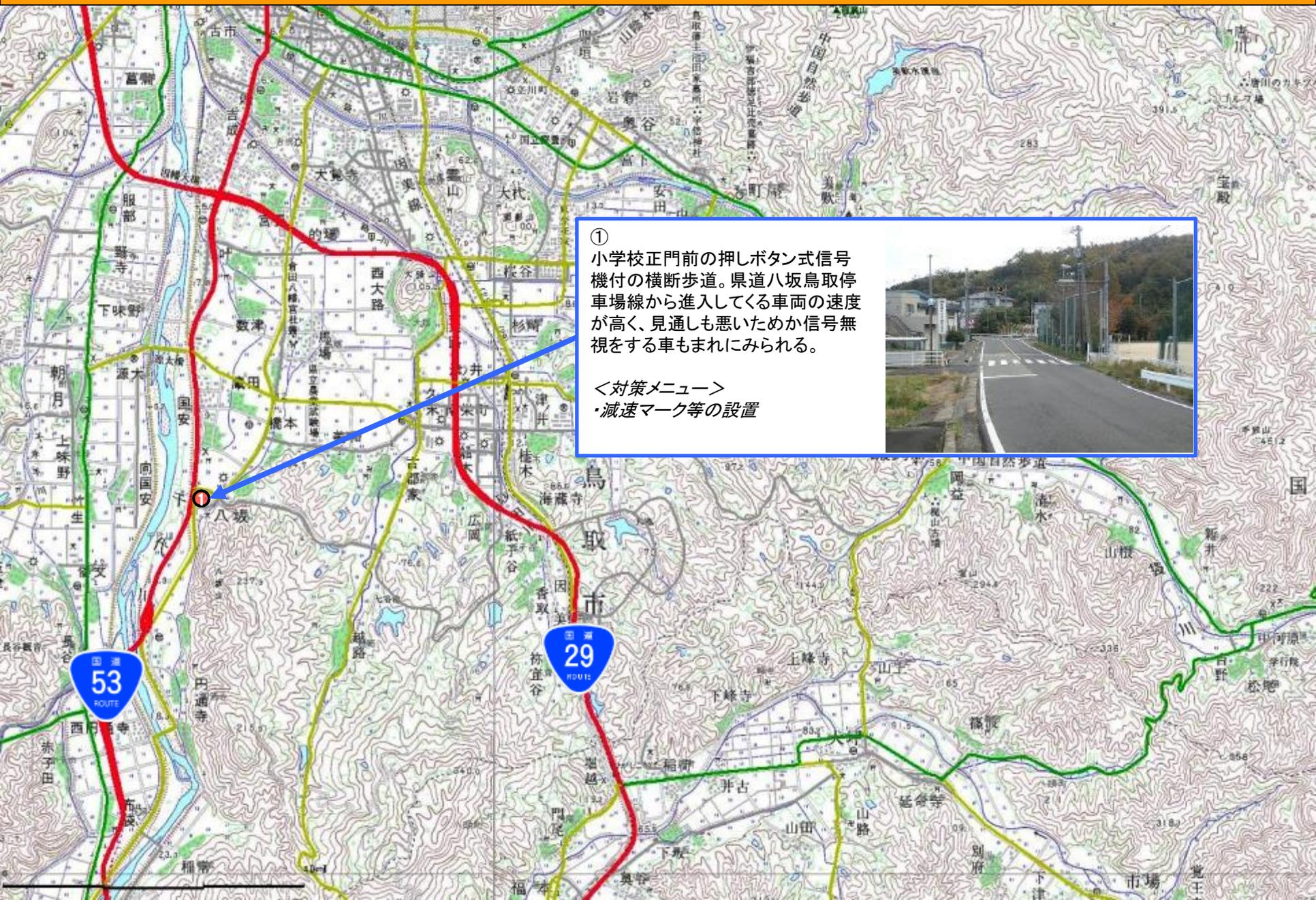
① 小学校正門前の押しボタン式信号機付の横断歩道。県道八坂鳥取停車場線から進入してくる車両の速度が高く、見通しも悪いためか信号無視をする車もまれにみられる。
