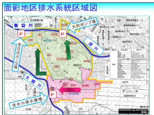
した場合には、樋門を閉じると同時に、鳥取市が設置している大杵ポンプ場と東吉成ポンプ場、そして洗井川と大路川の合流地点に鳥取県が設置している洗井川排水機場の3つのポンプ場で地区内の水をポンプアップし、強制的に河川に排水しています。
