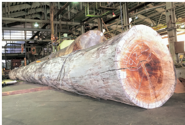
継ぎ目のない冠木は、幹径2mに及ぶケヤキの大木から製材された。樹齢は130年を超える。
