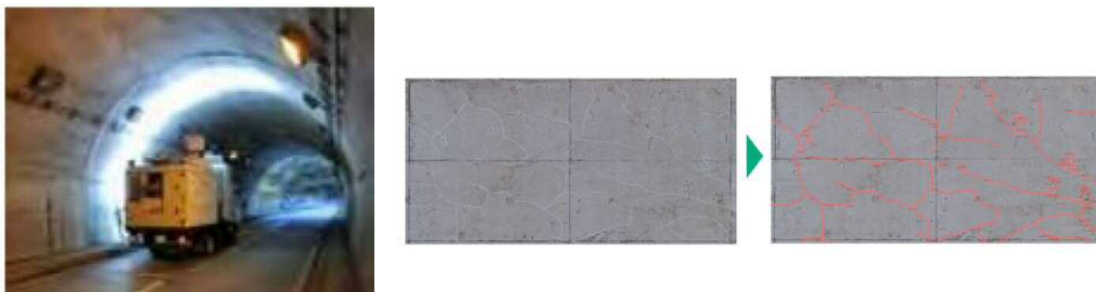
図 4.7 定期点検・詳細調査での新技術イメージ（左：画像計測技術、右：画像診断技術）
