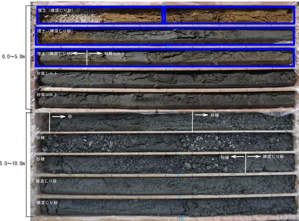
図-3.1 ボーリング柱状図【地点 No.1】 *拡大図を巻末に添付
