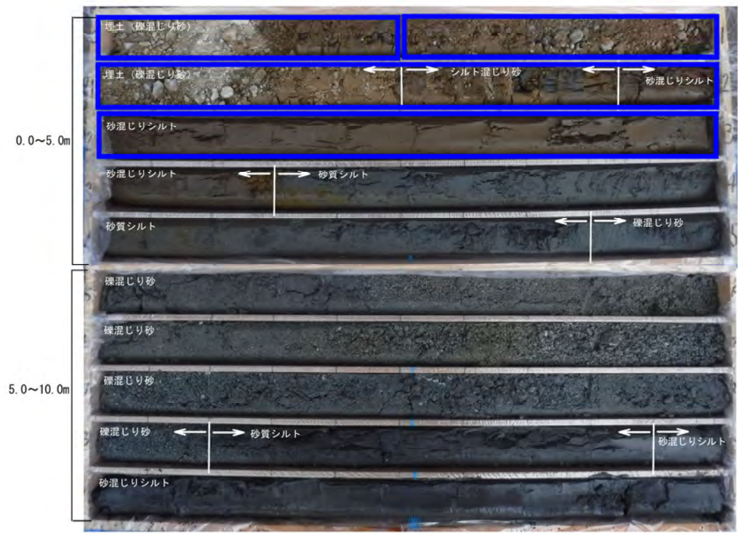
図-3.2 ボーリング柱状図【地点 No.2】 *拡大図を巻末に添付
