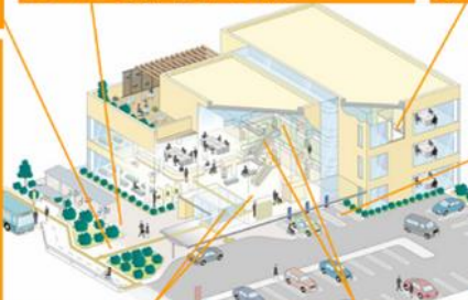
玄関や窓口業務事務室の出入口の自動ドア化 緩やかな勾配の手すり付き階段 車いす使用者も楽に通過できる廊下
