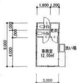
管理棟 (A) 平面図 S=1/200 × 2 棟
