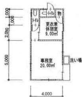
管理棟 (B) 平面図 S=1/200 × 1 棟
