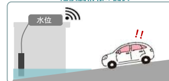
危険箇所に設置した水位計及び危険度情報の提供
