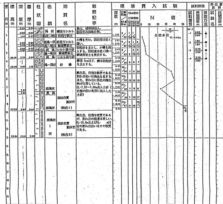
鳥取市ごみ焼却処理施設建設工事のうち地質調査業務 地質柱状図(孔番号: BP-9)
