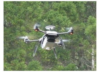
(ドローン等による航空レーザ測量)
